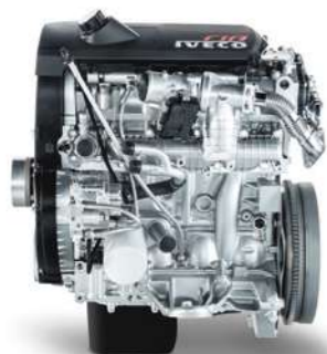
2,3-liter F1A dieselmotor met SCR
